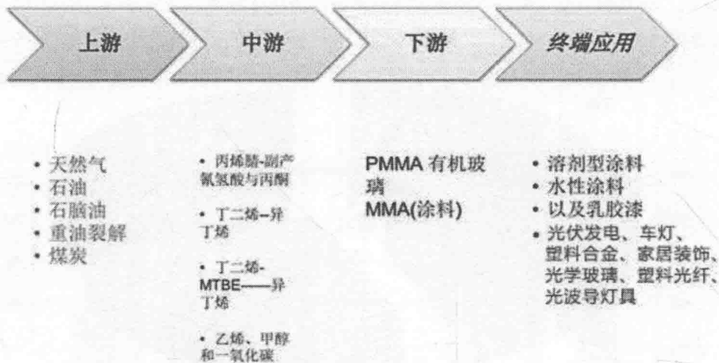
图 8 MMA 及 PMMA 产业链简图
