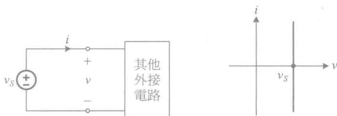
(a)理想電壓源與其他外接電路 (b)理想電壓源的 v - i 特性曲線
