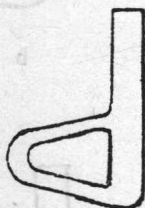
图 1-7 熔点测定管 (梯勒管)
