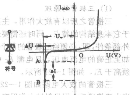
图 1—19 稳压管符号及稳压特性曲线
