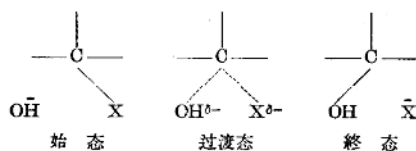
图5 氢氧离子对饱和碳原子的亲核侵蚀
