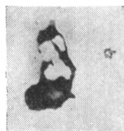
圖 12 ( \text{Mn}, \text{Fe} ) \text{O}\cdot\text{SiO}_2\sim\text{FeS}\cdot\text{MnS} 複相夾雜物, \times 500 頂端為含 Mn 高的 \text{FeS}\cdot\text{MnS}
