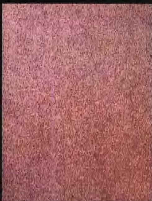
图5-26 钢铁喷砂除锈CSa3等级
