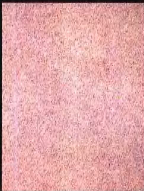
图5-25 钢铁喷砂除锈BSa3等级
