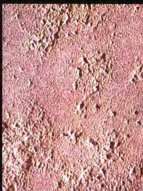
图5-27 钢铁喷砂除锈DSa3等级
