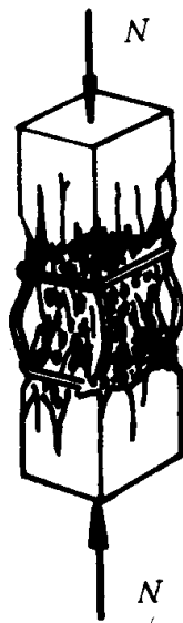
图 8-5 轴心受压短柱的破坏形态
