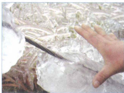
2008年冰灾 • 结在高压线上的冰柱直径达12cm。
