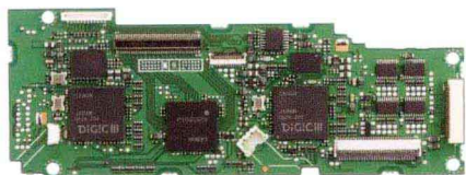
数码单反相机内部的信号处理芯片
