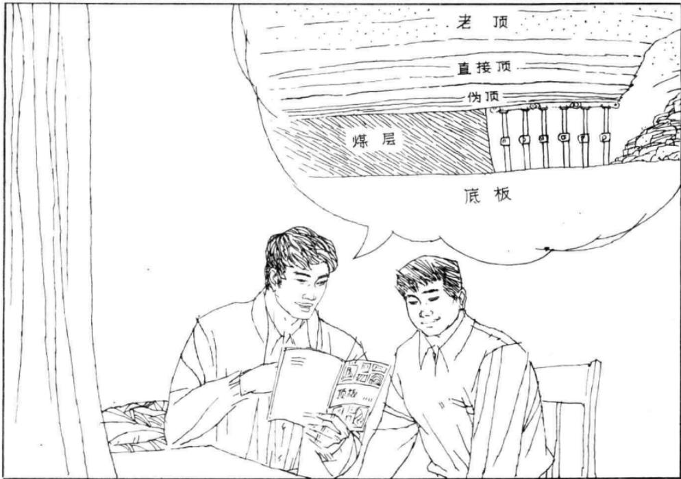
11. “煤层上面的岩层叫顶板，煤层下面的岩层叫底板。根据岩层的性质和厚度，顶板又分为伪顶、直接顶和老顶。”我指着书上的图给他讲解。
