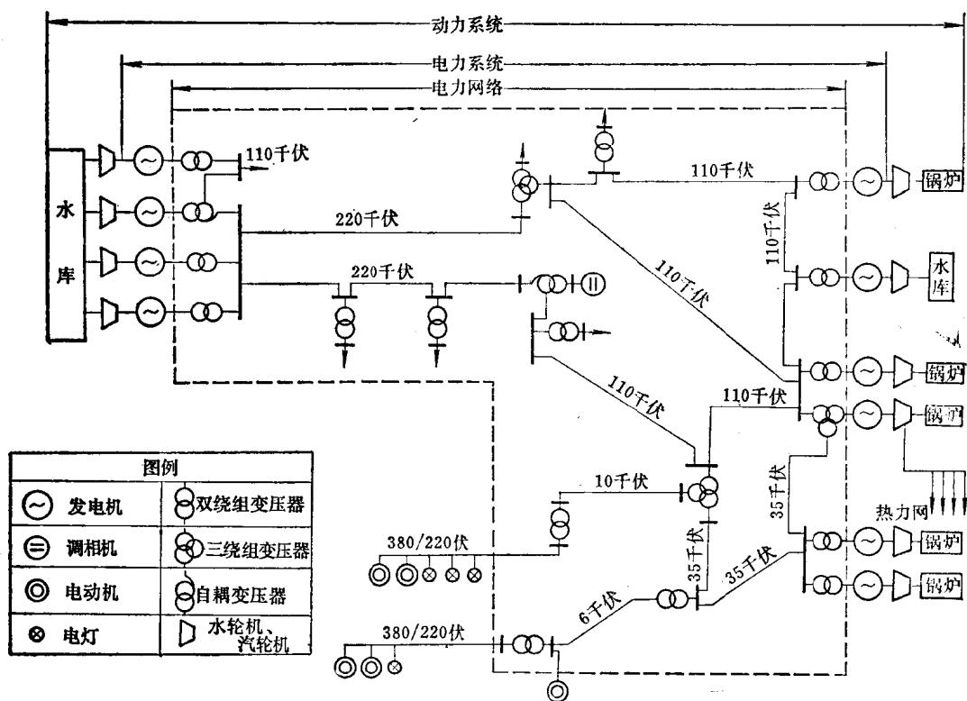
图 1-1 动力系统、电力系统、电力网络示意图
