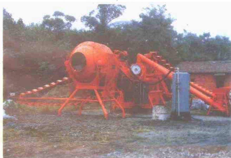
PH30—101A型混凝土喷射机，适用于铁道隧道、矿山巷道、引水隧道、井、斜井井筒、地下厂房仓库、铁路公路边坡防护等混凝土工程。
