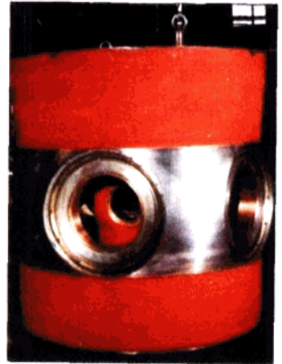
▲1.8万千瓦水轮机 转轮体 不锈钢件 重量：11吨
