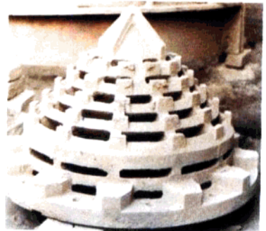
▲塔篦子顶帽 耐热钢件 重量：1.8吨
