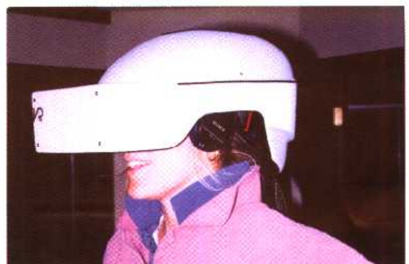
图2-22 虚拟现实系统用的头套(Virtual Research 提供)
