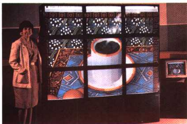
图2-36 MediaWall: 多屏幕显示系统。以 3 \times 3 监视器阵列显示图象, 由 Deneba Softwar 创建(RGB Spectrum 提供)
