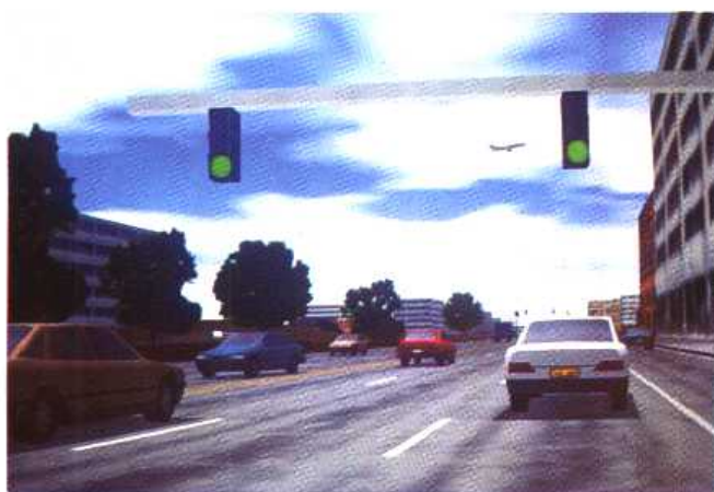
图1-37 用来测试驾驶员反应的汽车模拟系统的视景(Evans & Sutherland公司提供)
