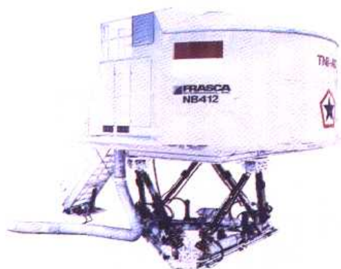
图1-34 一个全彩色视觉系统和六自由度运动的大型嵌入式模拟器(Frasca International 提供)
