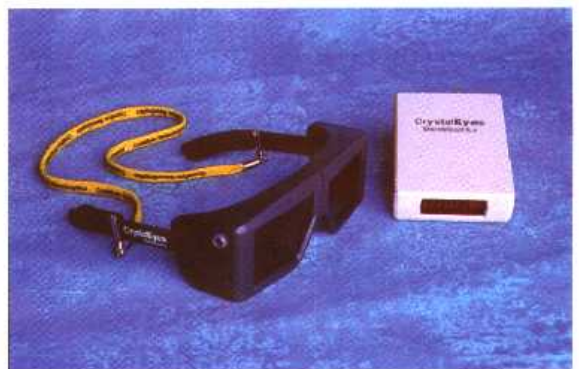
图2-21 观察立体感场景的眼镜,并配有红外线同步发射器(StereoGraphics 公司提供)
