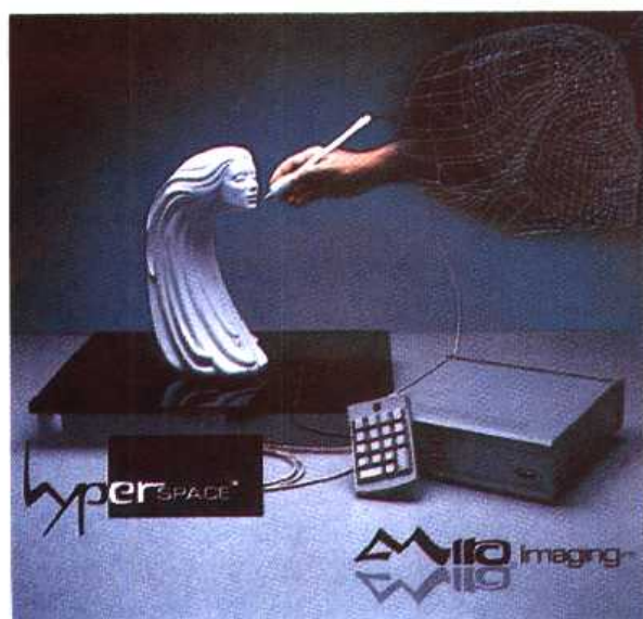
图2-47 Apple Macintosh 计算机采用的三维数字化仪系统(Mira Imaging 提供)
