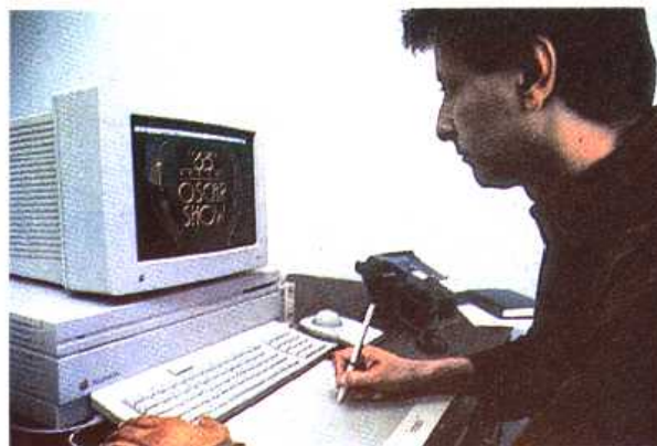
图2-46 美术家数字化仪系统, 带压力传感, 无绳触笔(Wacom Technology 公司提供)
