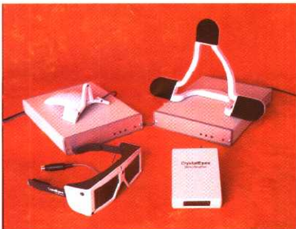
图2-24 与立体眼镜配用的跟踪头部位置的超声波跟踪设备(Stereo Graphics 公司提供)
