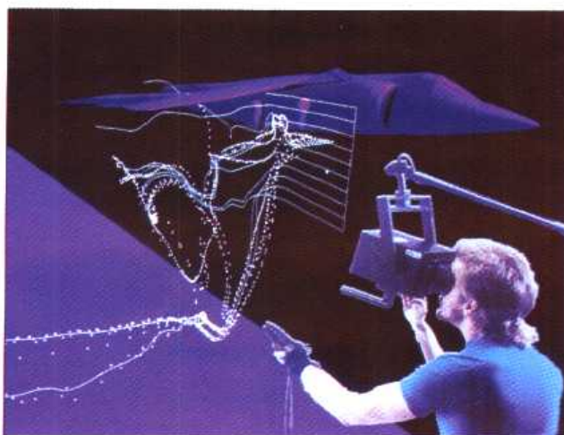
图8-14 使用一个称为BOOM(Fake Space实验室)和一个数据手套(VPL公司), 研究员交互地操纵Harrier喷气式飞机四周的不稳定气流中的探针。软件由 Steve Bryson 开发, 数据由 Harrier 提供(NASA Ames 研究中心 Sam Uselton 提供)
