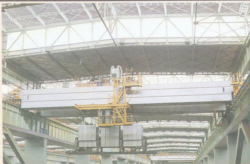
熱板坯用夾鉗式起重機吊運
