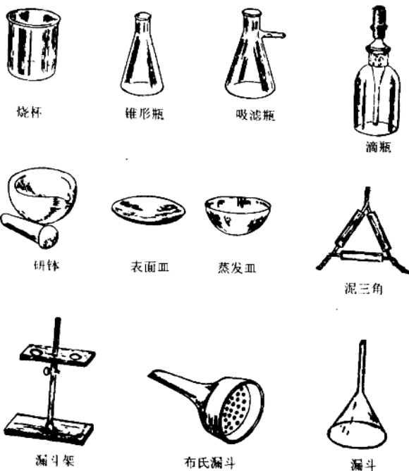
图 I-1.1 普通化学实验常用仪器
