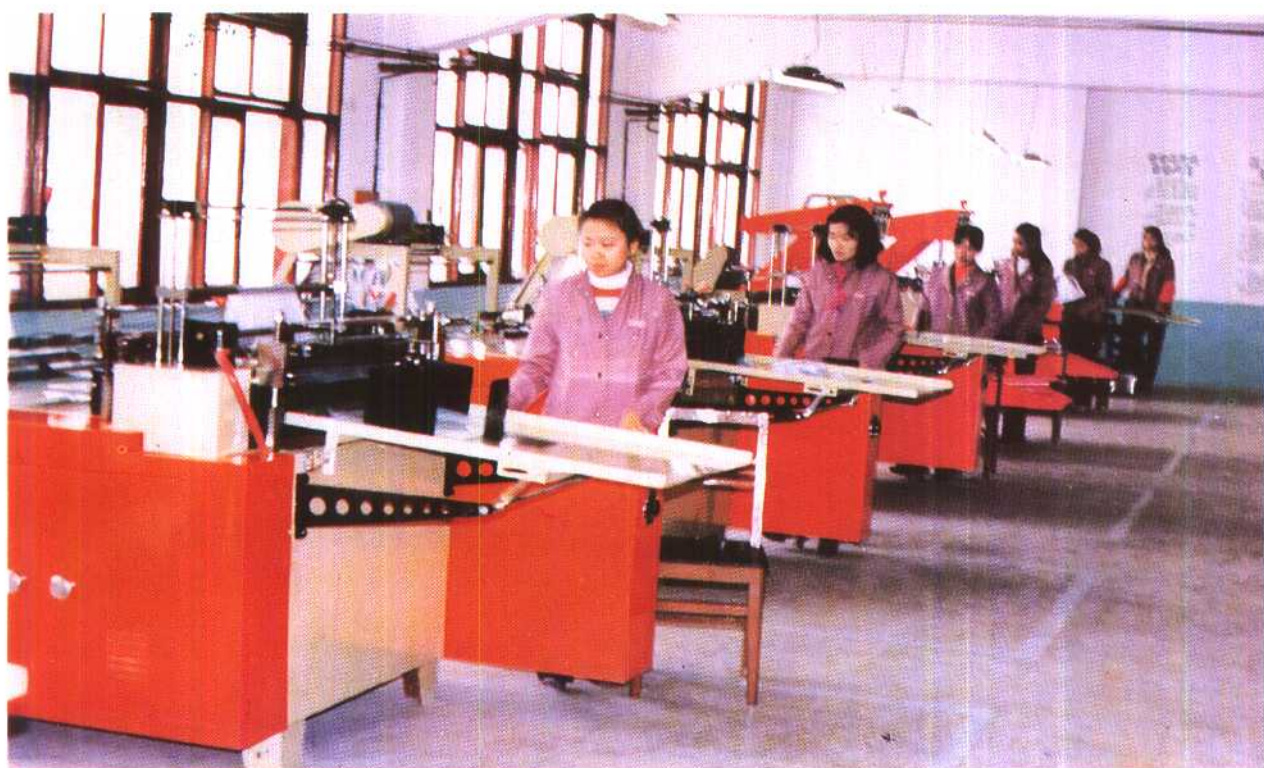
贵阳塑料一厂是轻工业部农地膜生产定点厂，省级先进企业。生产农地膜、工业薄膜、背心袋等十余个品种，其中农地膜一直保持省优质产品称号。图为该厂引进台湾的塑料背心式手提袋、彩印袋生产线制袋机。
