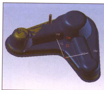
固定轴曲面轮廓铣切削模拟
