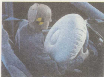
图 1-2-1 叠氮化钠受到强烈撞击后分解，产生的气体迅速充起汽车安全气囊
