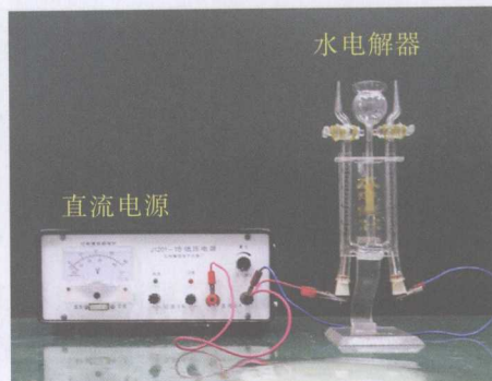
图 1-2-7 水的电解装置
