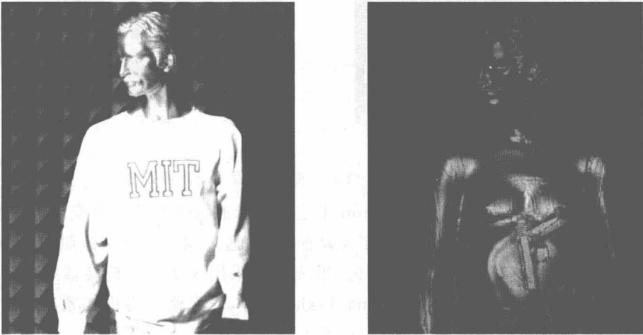
图 1.3 光学图像(左)和 100~112 GHz 宽带毫米波图像(右)
