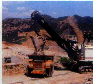
南芬露天矿 295B 电铲与 154t 汽车采场作业
