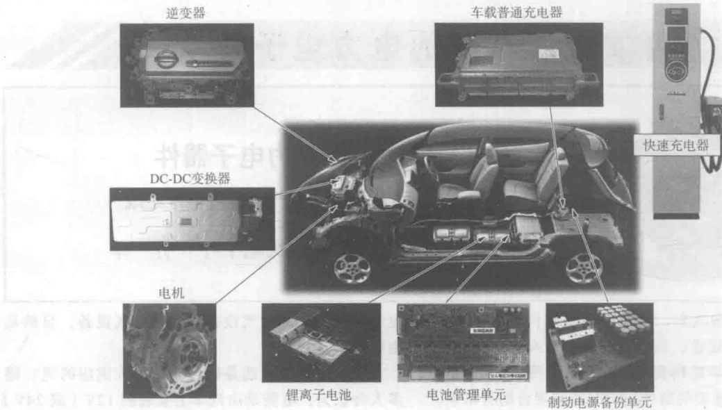
图1 日产聆风系列（早期型）中的电力电子系统相关部件
