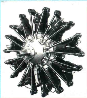
图 1-7 星型发动机示意图
