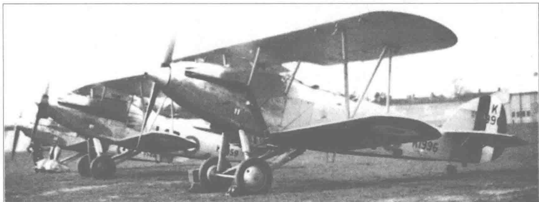
“奥达克斯”是风格和典雅航空的代表，这张照片展示了其优美的身姿。在其蒙皮下，这种双座轻型轰炸机的内部具有独特的钢管结构，是在卡姆的主导下研发的。
