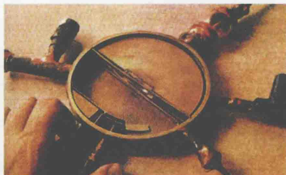
1930 年 E.O.劳伦斯制成世界上 第一台回旋加速器
