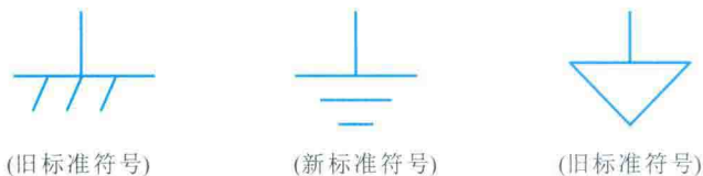
图 1-5 “地”的电路图形符号
