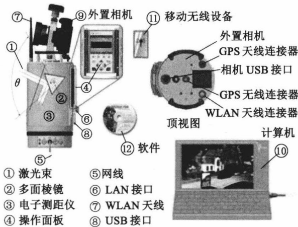
图 1-7 VZ-400 激光三维扫描测量系统
