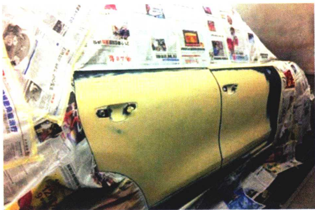
图1-9 局部喷漆时用报纸遮挡
