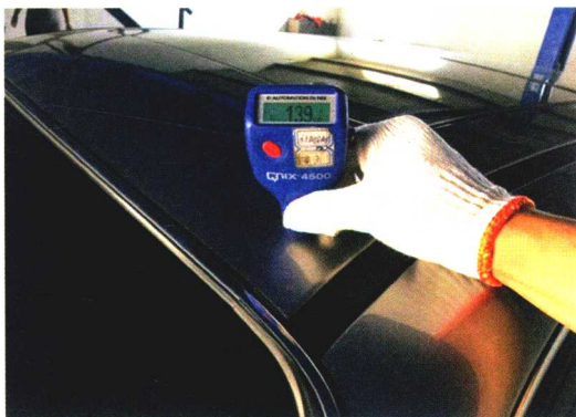
图 1-23 采集漆膜厚度基准数值
