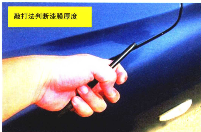
图1-8 敲打车漆表面判断是否喷过漆
