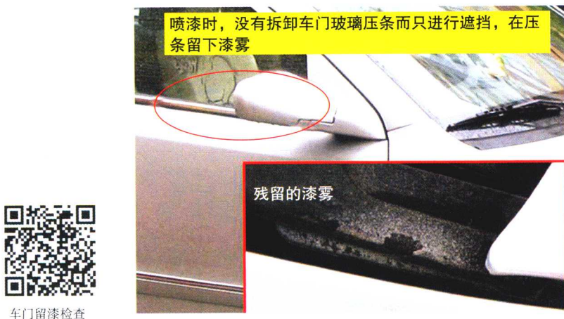
图 1-13 车门玻璃压条在车门喷漆时留下的漆雾
