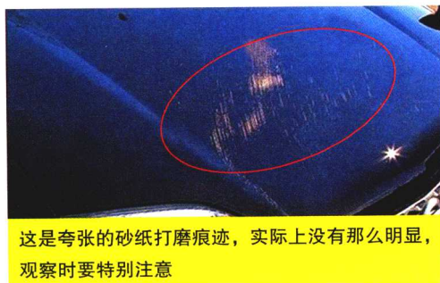
图 1-6 漆面留下的砂纸打磨痕迹
