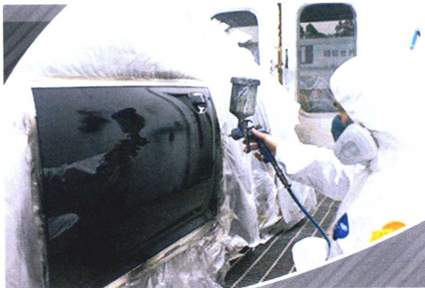
图1-10 局部喷漆时用薄膜遮挡
