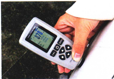
图 1-22 钣金修复右前翼子板后 漆膜厚度为 378\mu\text{m}
