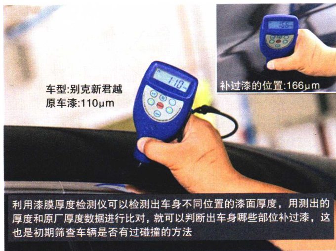
图 1-20 漆膜厚度检测仪的使用
