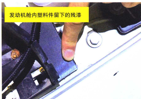
图 1-15 发动机舱内翼子板塑料件侧留下残漆
