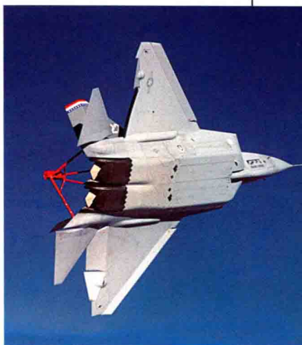
上图：YF-22A（N22YF）装备螺旋改出伞。请注意其飞机舵面、副翼、襟翼和水平尾翼的位置。
