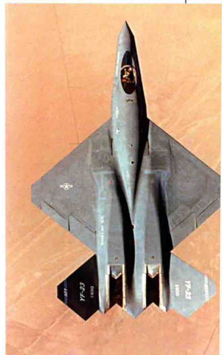
下图：YF-23A的翼平面形状与传统设计相当不同。
