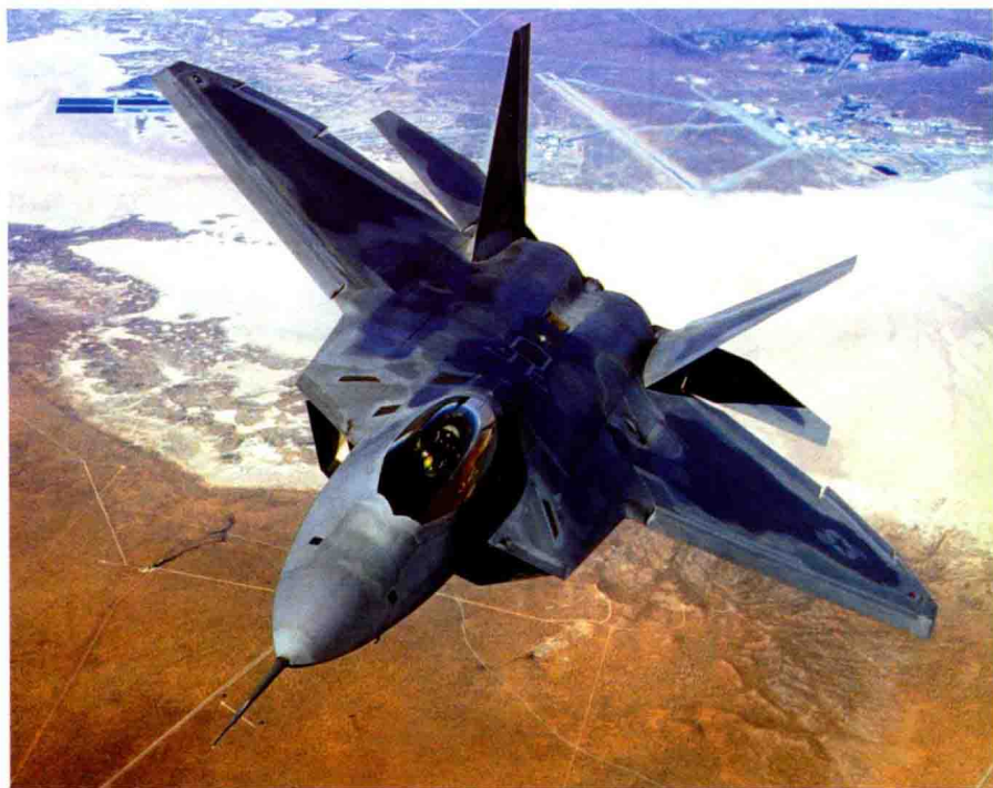
上图：尽管F-22A的设计初衷是通过隐身性能、先进的航电设备和智能武器的结合，进行超视距（BVR）战斗，但是它也具备近距离格斗必需的机动能力。
