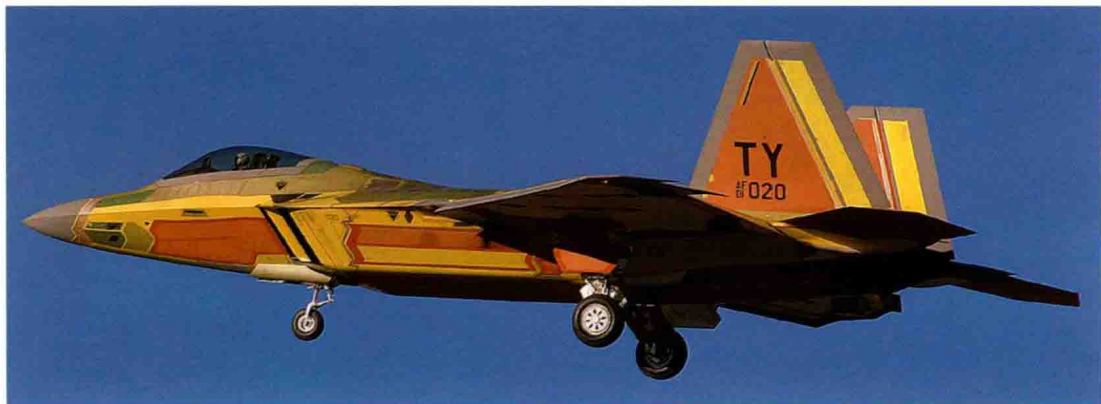
左图：一架尚未完成雷达波吸收材料覆层的F/A-22A（01-4020），拍摄于乔治亚州玛丽埃塔制造中心。
