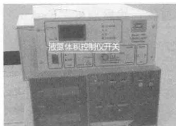
③ 打开左侧舱门, 开启仪器主电源开关:
