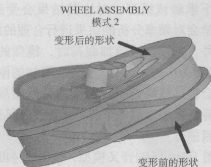
图 1-2 车轮变形前后的形状对比
