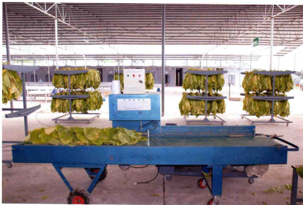
21世纪初期烟叶工场使用的 机械化绑杆设备。
