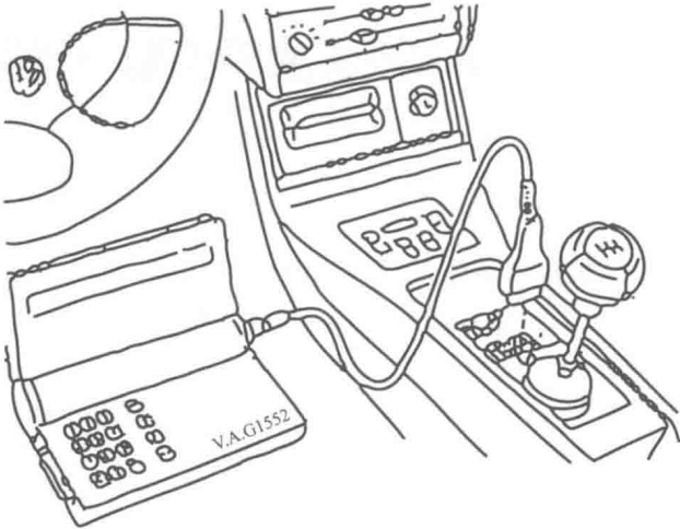
图 1-11 V.A.G1552 故障诊断仪与诊断插口的连接
