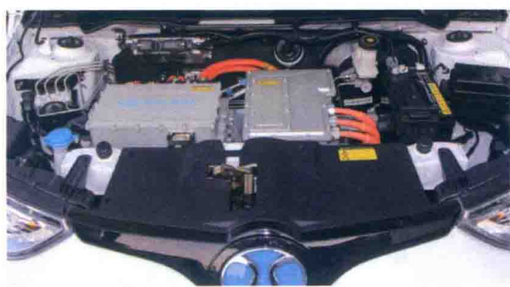
图 1-3 前机舱高压部件及橙色线束(北汽EC200)
