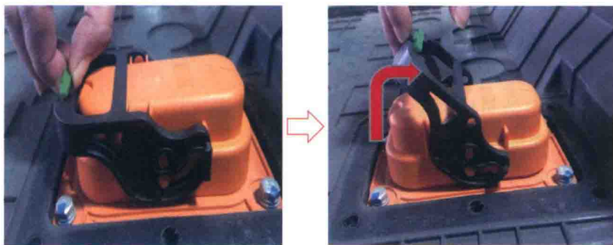
图 1-11 取出维修开关
