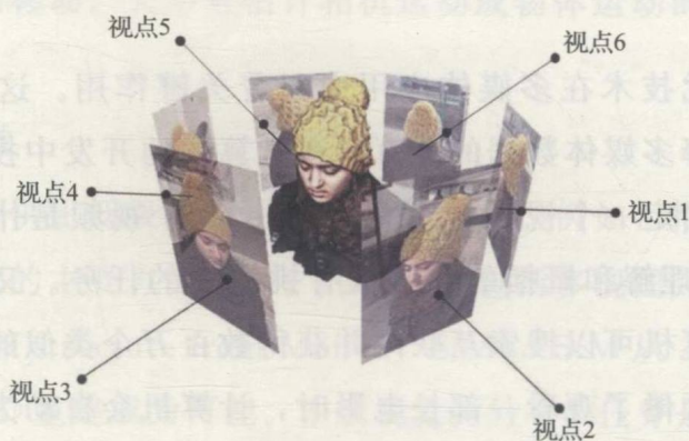
图 1.2 给定一组从六个不同视点捕获的对象(例如，人体上半身)的图像，可以使用计算机视觉算法重建对象的密集三维模型
