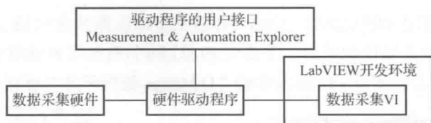
图 1-3 基于 LabVIEW 的数据采集系统结构
