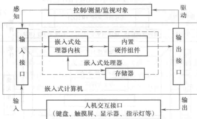
图 1.2 嵌入式系统硬件的逻辑组成
