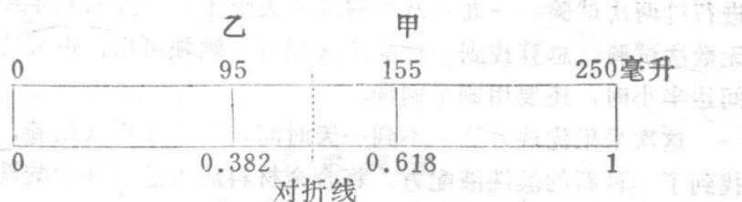
点左侧的纸条（即淘汰小于95毫升的试验点），得出新的试验范围（即95至250毫升），再将剩下纸条对折起来，折到甲的对称点丙为190毫升，作第三次试验（见图）。对比丙与甲的结果，知道甲比丙好，即将丙点右侧的纸条剪掉（即淘汰大于190毫升的试验点），又得出新的试验范围（95~190毫升），再同样对折找甲的新对称点作新的试验（见图）。如此循环，到第五次试验即找到硝酸配比最优为165毫升。第二步将硝酸含量
