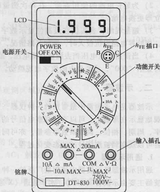
图 1-2 DT830 型数字式万用表面板结构
