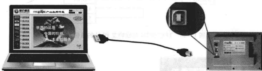
图 1-17 计算机与触摸屏的下载连接
