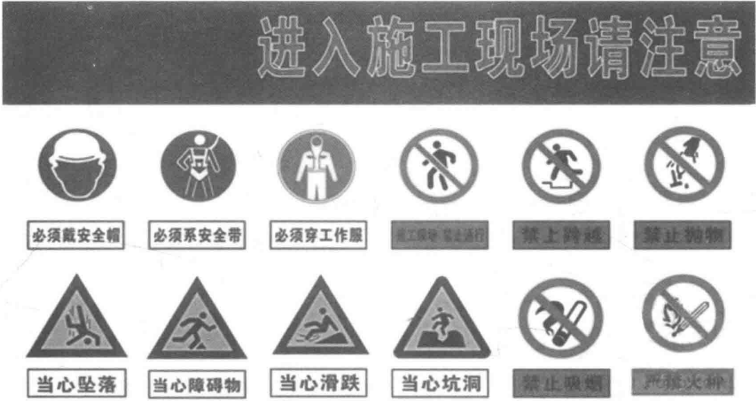
图 1-1-2 施工现场警示标志
