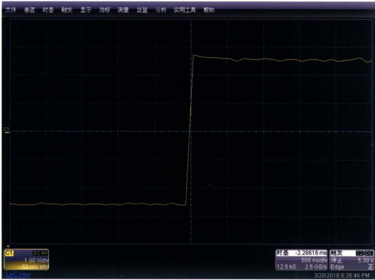
图 3-7 100Hz、10% 占空比的方波的上升时间小于 150ns
