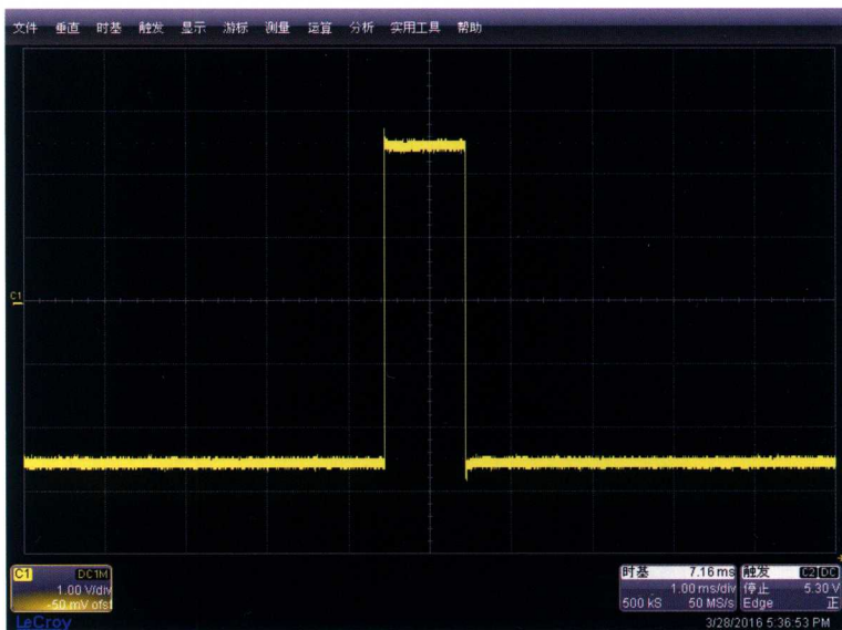
图 3-6 用示波器测量得到的 WF1974 产生的 100Hz、10% 占空比的方波波形图
