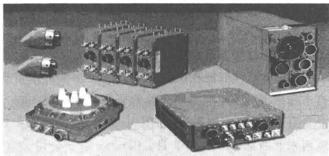
图 1-7 全数字式雷达告警接收机(RWR)
