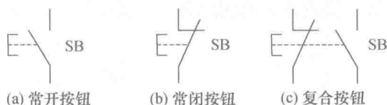
图 2-6 按钮图形符号和文字符号
