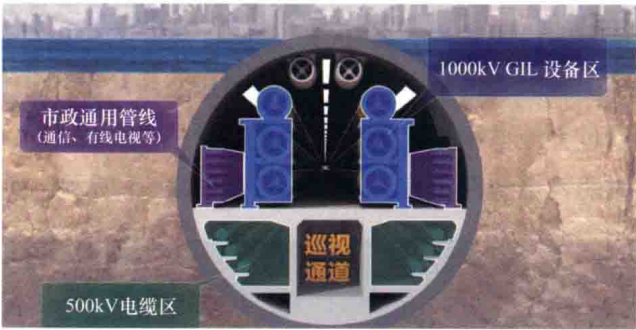
图 1-2 苏通 GIL 综合管廊工程隧道截面图
