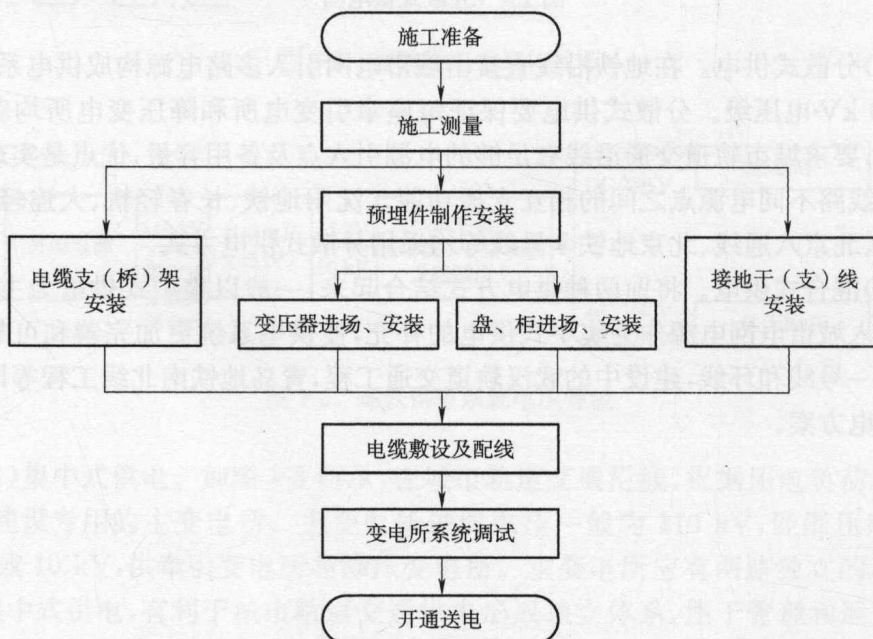
图 2-1 变、配电所施工流程图
