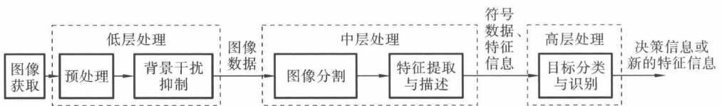
图 1.5 红外自动目标识别系统图像信息处理典型流程
