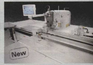
3586 自动扶边褶和后省缝纫工作站 Automatic sewing unit for darts and waistband pleats
